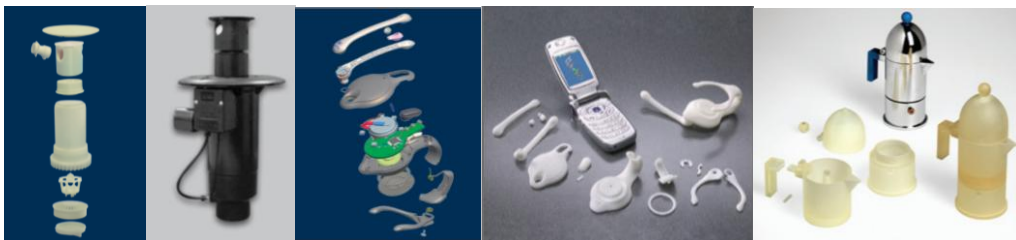
图10 利用 3D 打印对实现对洒水器、耳机、水壶构件进行装配验证
