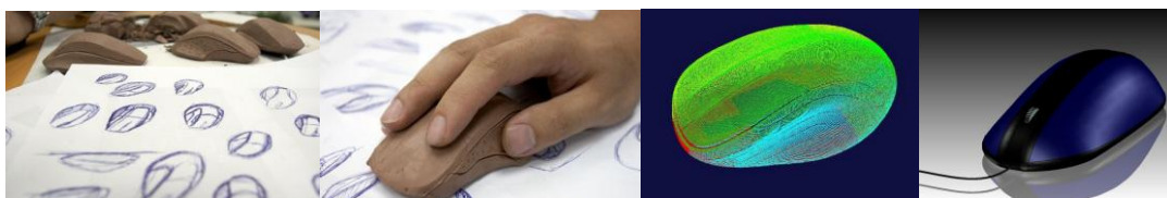
图5 油泥模型和3D扫描相结合，逆向设计鼠标
