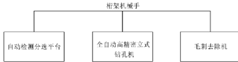
图1 全自动高精度大型轴承外圈径向钻孔生产线框架示意图
