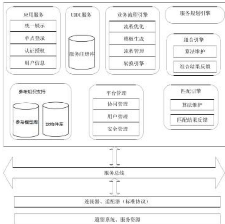
图 4 软件系统核心服务层结构
